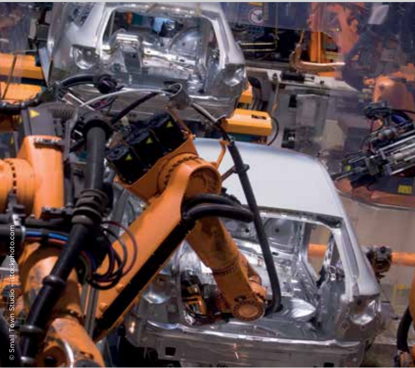
In einer PKW-Produktion überziehen Roboter Karosserieteile mit flüssiger Wachskonservierung
