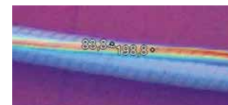
Konventioneller Heizschlauch: Parallelheizband als Wärmeträger
