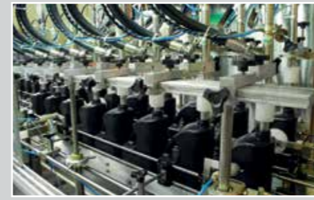
Co-Extrusion mit Kunststoffen. Transport verflüssigter Kunststoffgranulate in Heizschläuchen zum Extrusionswerkzeug. Optional: temperaturüberwachter Extrusionskopf mit integriertem Sensor im Werkzeugkopf. Heizleistungen: 60-140 W/m
