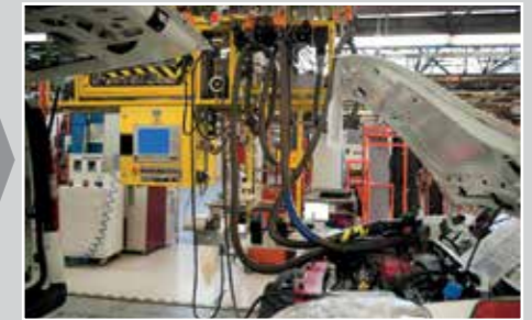
Wachsförderschläuche, Heizleistung 60-120 W/m, Beheizung mit minimierten Toleranzen zur Gewährleistung einer extrem gleichmäßigen Konsistenz
