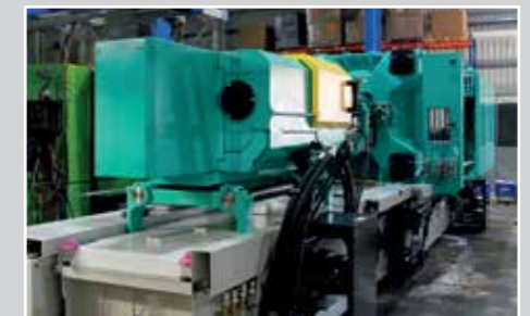
CNC-gesteuerte Spritzguss-Produktionsmaschine. Temperierung von Kunststoff und Kleber im Heizschlauch bei Herstellung von Gehäuseteilen (PA, TPE, EVA) Mediumtemperatur: +90°C - +180°C
