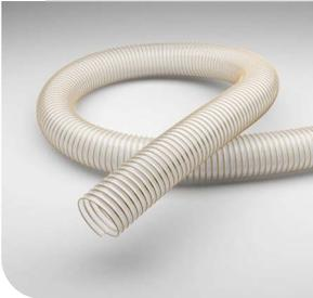
PU Absaug-/Förderschlauch, sehr flexibel, Oberflächenwiderstand  $< 10^9$  Ohm, permanent antistatisch, mikrobeneutral, schwer entflammbar
