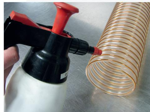
3. Befreien Sie ebenfalls das Innengewinde des PU-Schraubteils von Schmutz und Fettresten
